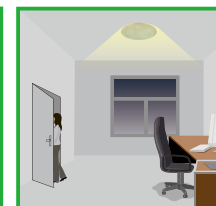
Lorsqu'aucun mouvement n'est détecté, le capteur se met en période de „Temporisation“. Lorsque la „Temporisation“ est écoulée, le capteur se met en période de „Temps de veille“.
