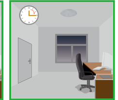
Het licht wordt uitgeschakeld wanneer de "Standby-tijd"-periode voorbij is.
