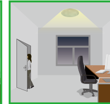
Wanneer er geen beweging wordt gedetecteerd, gaat de sensor over op de "Wachttijd"-periode. Als de "Wachttijd"-periode voorbij is, gaat de sensor over op de "Standby-tijd"-periode. Gedimde lichtafgifte (10%/20%/30%/50%).
