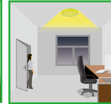
Met beweging en onvoldoende natuurlijk licht. Het licht wordt ingeschakeld (100% lichtsterkte).
